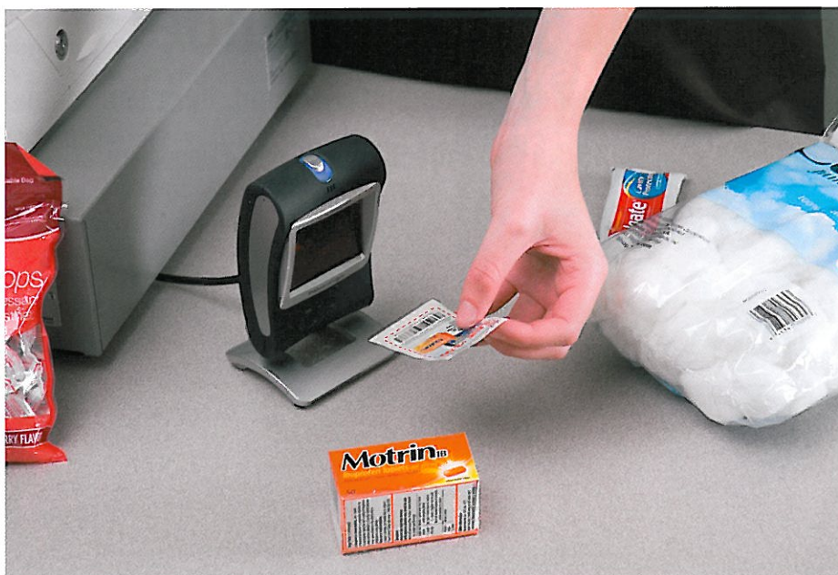
Mit diesem Präsentationsscanner aus dem Hause Metrologic können nicht nur Print-Barcodes sondern auch Barcodes vom Handy eingelezen werden.
